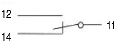
Situación contacto auxiliar con interruptor cerrado
